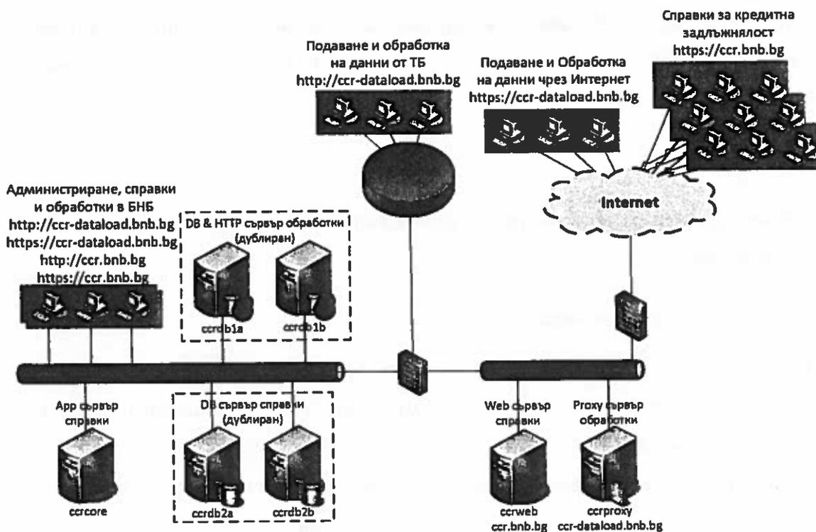
За всички комуникации между компонентите на системата като базов протокол се използва TCP.
