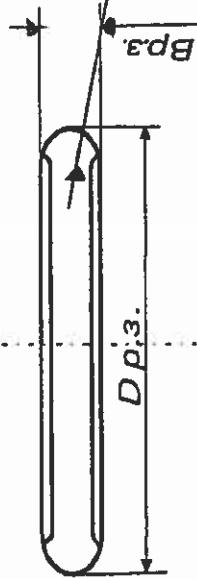
Радиус на закръгление ( $B_{p,3}$ ) 3.00 мм.
